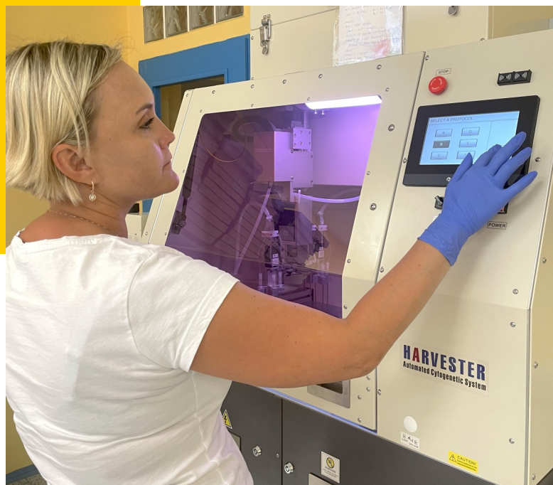
Vrchní laborantka cytogenetické laboratoře v Novém Jičíně Lucie Vašková u nového přístroje, který plně nahrazuje ruční práci při přípravě preparátů ke stanovení karyotypů.
